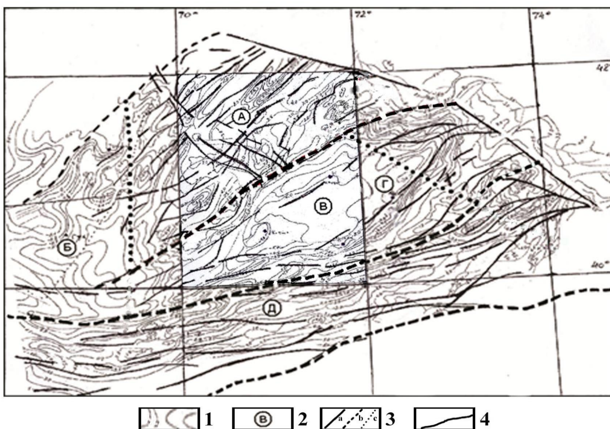
Рис. 1. Карта амплитуд новейших тектонических движений Западного Тянь-Шаня. 1 – амплитуда новейших тектонических движений; 2 – неотектонические районы; 3 – границы неотектонических районов: а – совпадающие с зоной разлома первого ранга; b – совпадающие с краевыми разломами второго ранга; с – границы районов, выраженные амплитудными характеристиками неотектоники и другими геолого-геофизическими параметрами; 4 – активные разломы.
